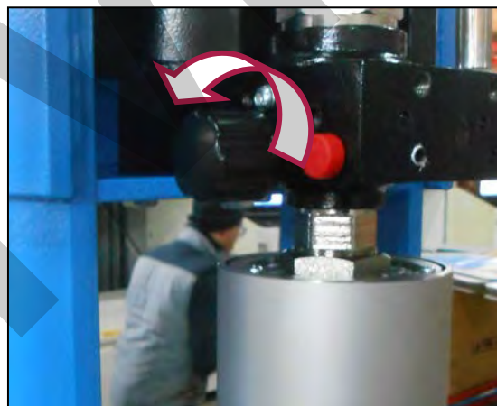
Figura 18 – Valvola di scarico.
