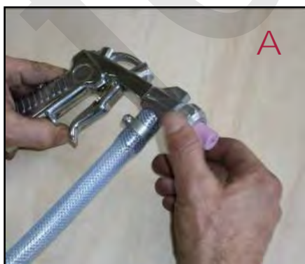
Figura 23 - Smontaggio dell'ugello della pistola sabbiatrice.
