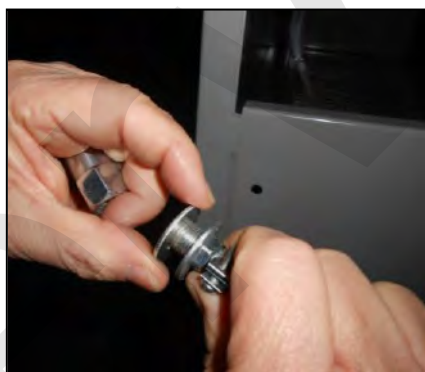
Figura 14 - Collegamento della pistola sabbiatrica
